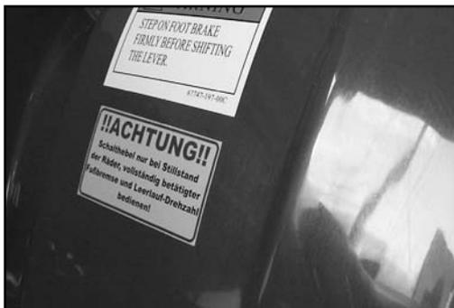
An der Maschine sind Hinweis-Aufkleber zur richtigen Bedienung angebracht. Diese dürfen nicht entfernt werden. Sollten die Aufkleber beschädigt sein oder fehlen, sind diese umgehend zu ersetzen.
