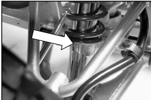
Einstellung mit einem speziellen Hakenschlüssel nach rechts (= härtere Federung) oder nach links (=weichere Federung) drehen.
