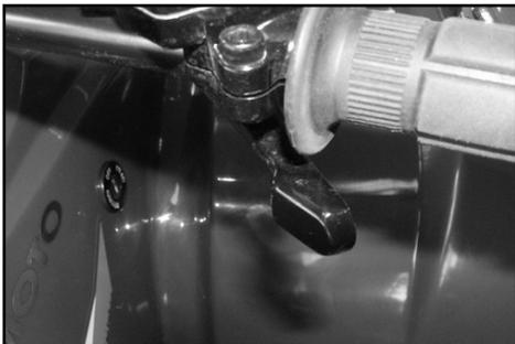
Kontrollieren Sie den Gaszug durch Drehen des Gashebels von Leerlauf bis Vollgas auf Leichtgängigkeit. Durch Bewegen des Lenkers kontrollieren, dass der Gaszug nicht scheuert.
