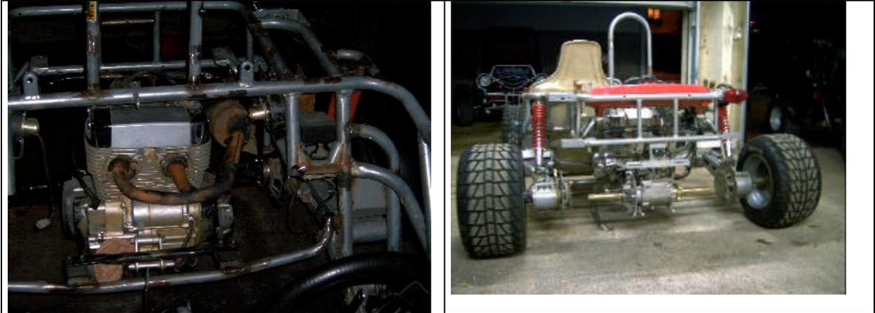
**L'inverseur est entraîné par une chaîne réglable, et les roues par des cardans qui peuvent s'allonger pour compenser le débattement des amortisseurs.**
