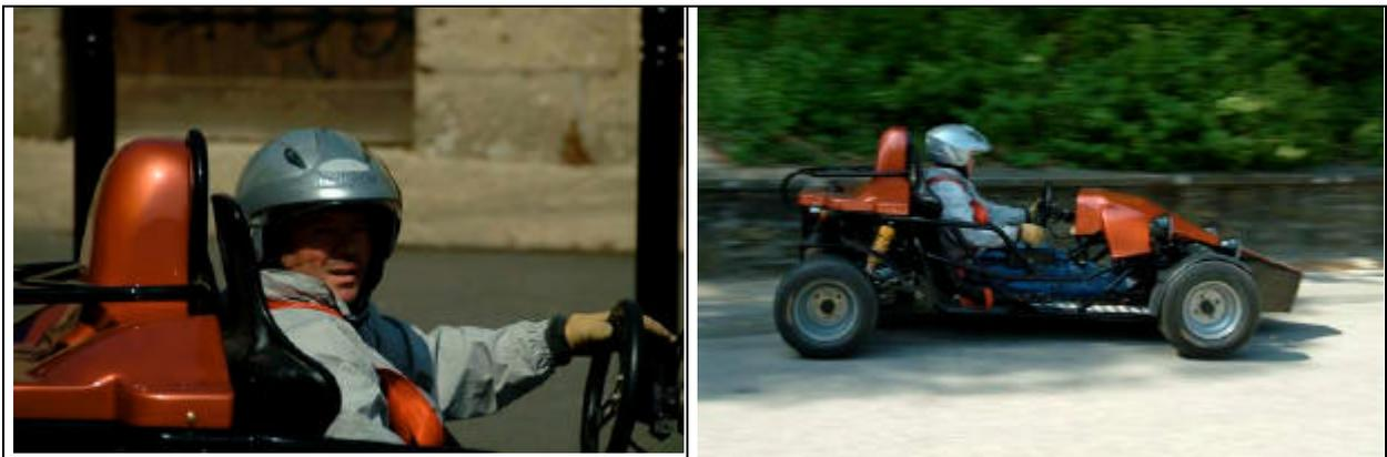
Passer la marche avant, débrayer au volant, pousser la première, embrayer progressivement : le buggy avance, le moteur prend rapidement de la vitesse, même si les pneus arrière ripent sur le goudron faute de différentiel. Il faut déjà passer la seconde, et surtout résister pour ne pas utiliser le pied gauche totalement inutile pour débrayer ! L'utiliser, c'est prendre le risque d'écraser le frein et de caler en pleine route !
